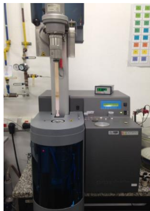
Figura 2. Dilatômetro Setaram Modelo Setsys Evolution TMA utilizado no experimento.
