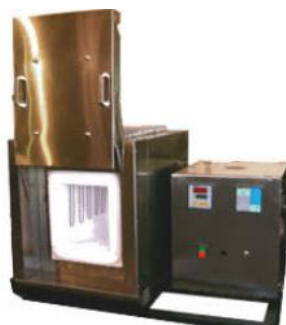
Figura 3. Forno utilizado na sinterização das amostras.
