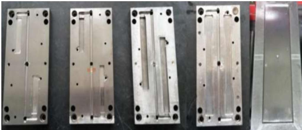
**Figura 1:** Matrizes para obtenção de corpos de provas
