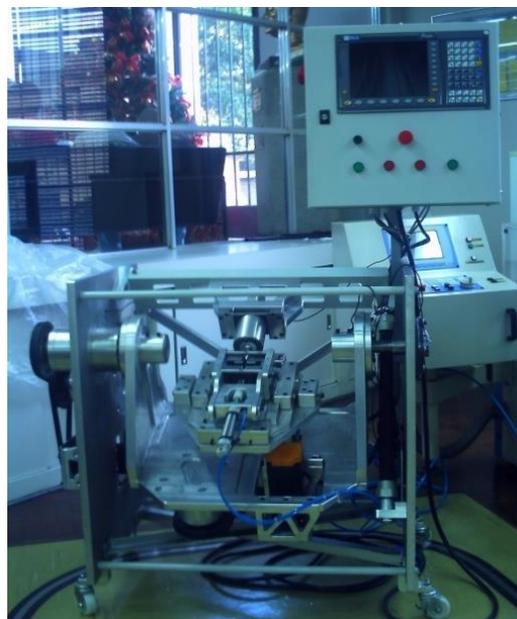
**Figura 2.** Máquina de Ensaio de Prótese Total de Quadril.
