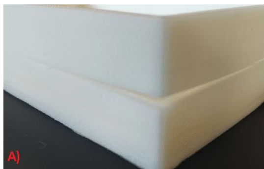
Figura 3. A) Case com descolamento de camada devido a retração do material ABS. Objeto impresso com base aquecida a 105 °C.
