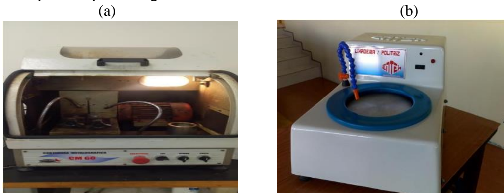
Figura 5. (a) Cortadora e (b) politriz metalográfica usadas no trabalho.
