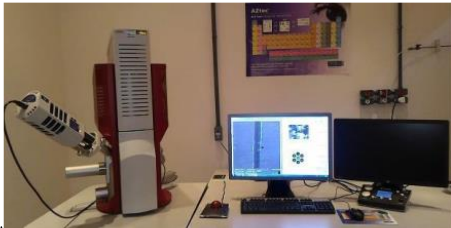
Figura 6. Microscópio eletrônico de varredura Tescan Mira 3 usado neste trabalho.
