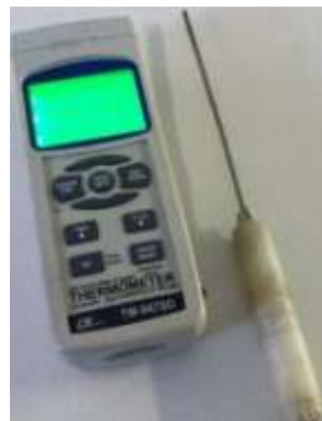
Figura 14. Termômetro LUTRON e termopar para captar temperatura.
