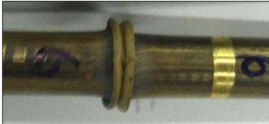
Figura 1. Rebarbas da soldagem.
