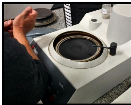
Figura 2. Peças serradas sendo lixada
