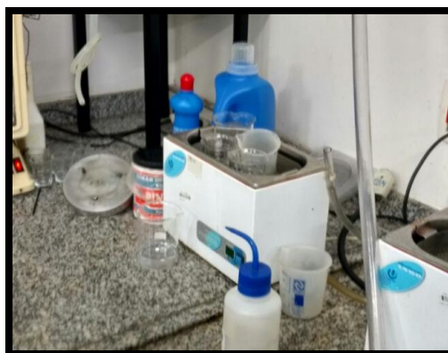
Figura 3. Amostras sendo limpadas para a análise por MEV
