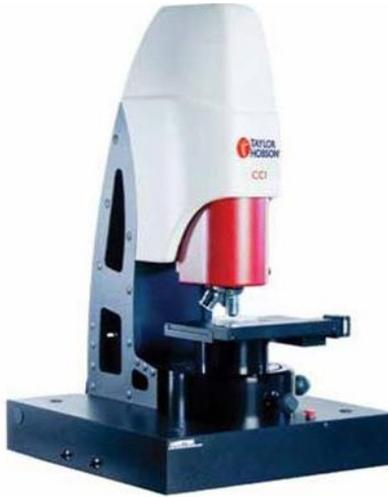
**Figura 3.** Perfilômetro utilizado na caracterização de rugosidade dos materiais cerâmicos. Fonte: (4)
