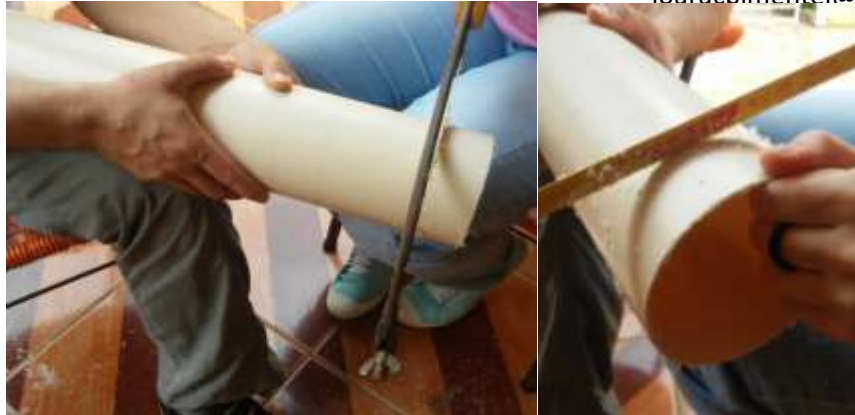
Figura 10: Corte manual sendo realizado no tubo de PVC.
