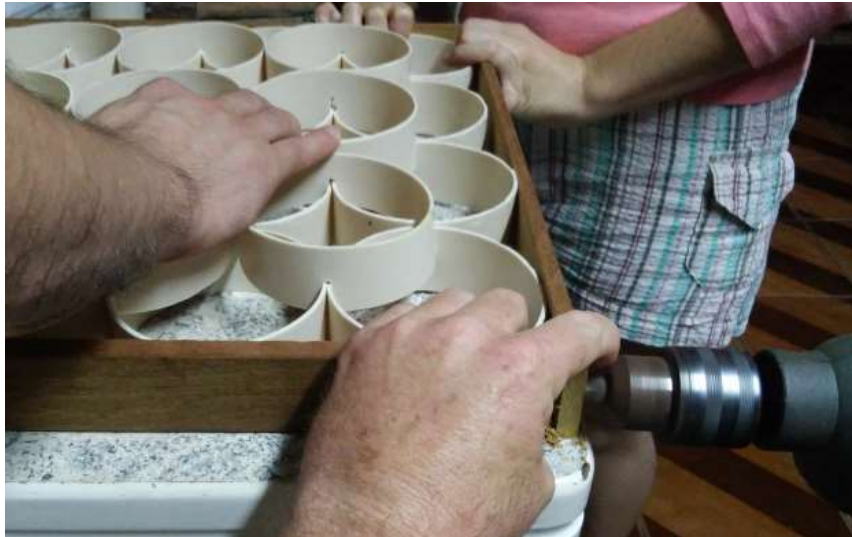
Figura 16: Fixação da moldura em madeira.
