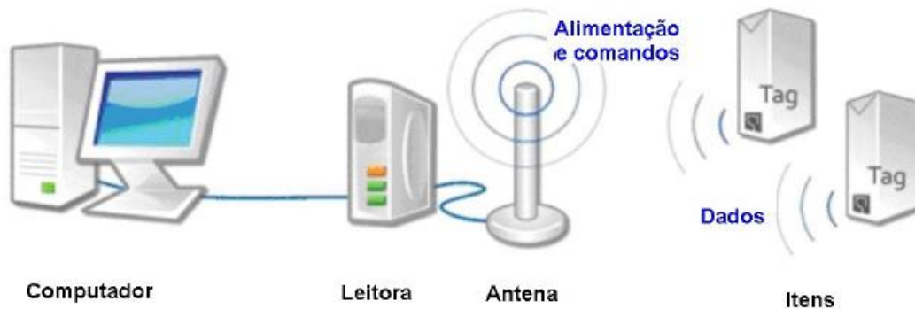
Figura 1. Componentes e funcionamento da tecnologia RFID [4].
