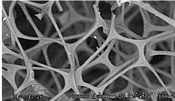
Figura 1. Microestrutura das fibras de melamina (9).
