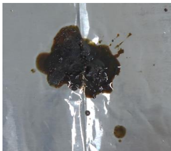
Figura 7. Resíduos gerados pela combustão da amostra da espuma acústica no anteparo.
