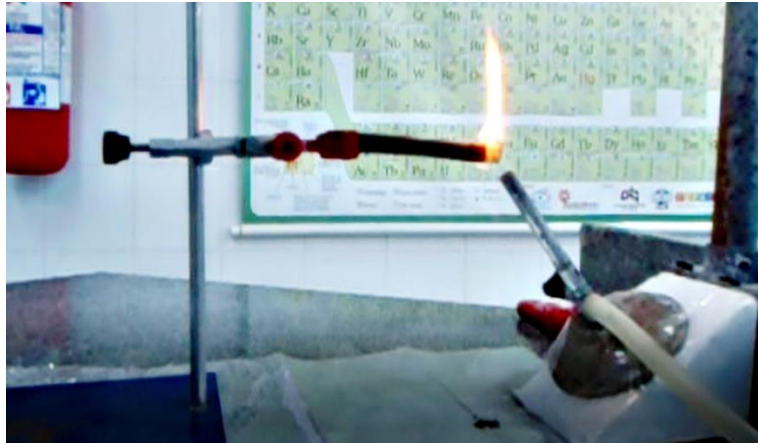
Figura 6. Amostra da espuma acústica no momento de exposição à chama.
